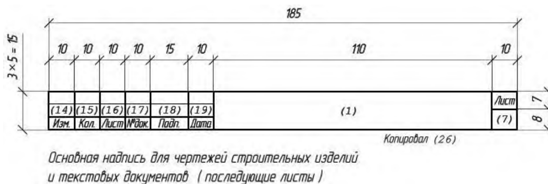
Рисунок 2. Основная надпись размером 185 x 15 на листах пояснительной записки
