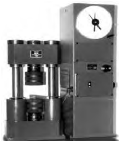
Рисунок 2 - Малогабаритная разрывная испытательная машина ИМ – 4Р
