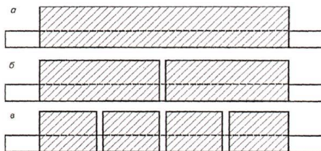
Рисунок 15 -Конструкция катодных секций. а - монолитная; б - двухсекционная; в - многосекционная.
