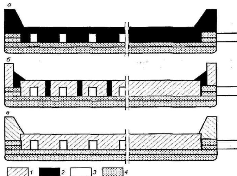
Рисунок 6 - Типы катодной углеродной футеровки.
