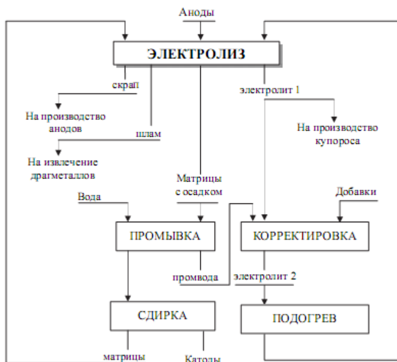
Рисунок 19 – Технологическая схема электролитического рафинирования меди
