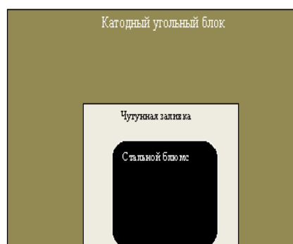
Рисунок 12 - Схема катодной секции
