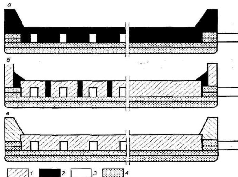
Рисунок 6 - Типы катодной углеродной футеровки.
