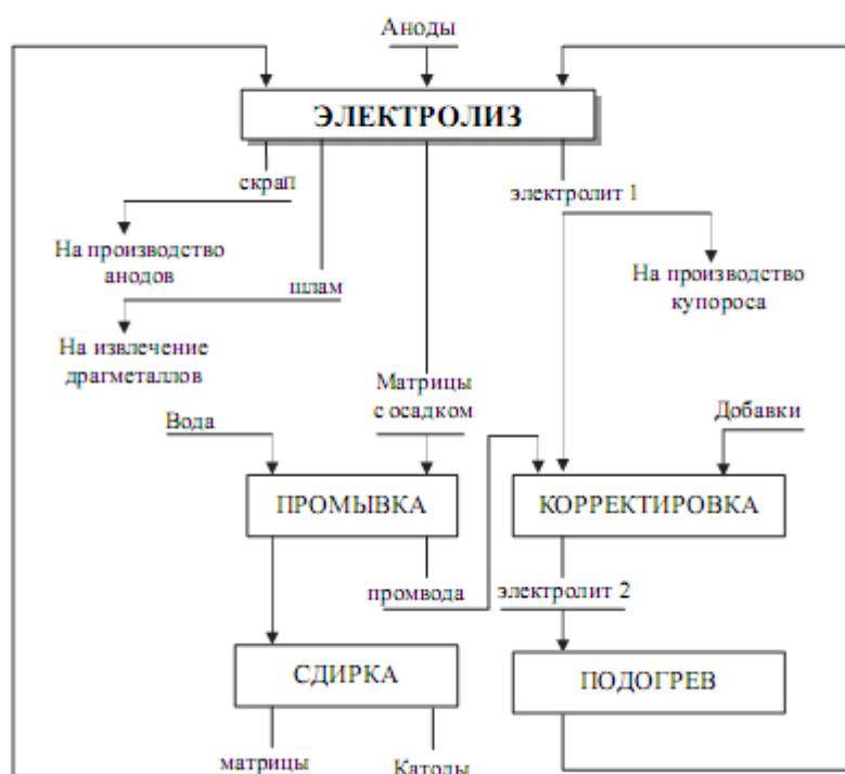
Рисунок 19 – Технологическая схема электролитического рафинирования меди
